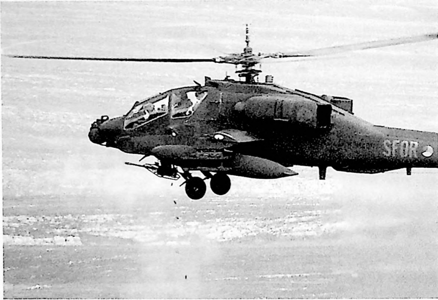
Het 30-millimeter snelvuurkanon in gebruik op Glamoc-range in centraal-Bosnië (Bron: Archief 301 Squadron)
