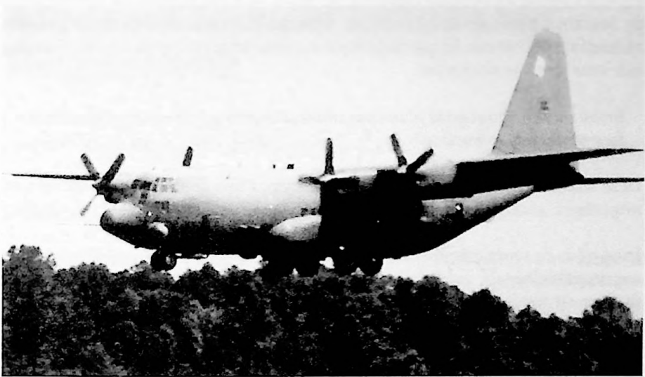
Afb. 9 De Hercules van het type C- 130 is een tactisch transportvliegtuig met een grote actieradius, dat geschikt is voor landingen op korte en onverharde vliegstrips. Hier is een afgeleide versie afgebeeld: AC- 130H Spectre gunship (Foto: Jane's)
